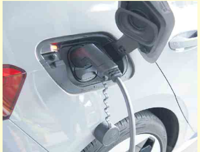
Anschluss in beide Richtungen. Beim bidirektionalen Laden dient die Batterie des E-Autos als zusätzlicher Energiespeicher für den Haushalt. Foto: DJD/E.ON/Malte Braun
