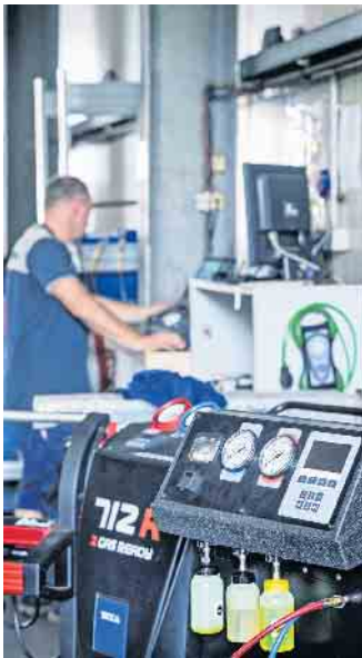
Mechaniker mit Sachkundenachweis für die Klimaanlagenwartung und professionelle Klimaservicegeräte stellen sicher, dass bei der Überprüfung der Fahrzeugklimatisierung nichts übersehen wird. Foto: DJD/Kfzgewerbe/Heike Wippermann
