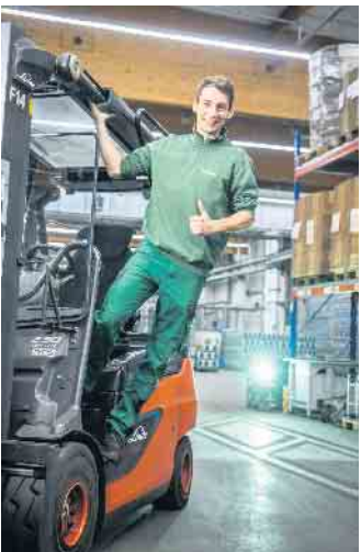
Der innerbetriebliche Transport erfolgt mit modernen Flurfördermitteln, die eingesetzten Gabelstapler können sechs Paletten gleichzeitig transportieren. Foto: DJD/Veltins
