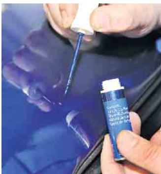
**Kleine Steinschläge im Lack lassen sich per Smart-Repair unsichtbar machen.** Foto: djd/Kfzgewerbe
