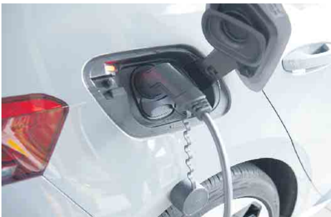
Anschluss in beide Richtungen. Beim bidirektionalen Laden dient die Batterie des E-Autos als zusätzlicher Energiespeicher für den Haushalt. Foto: DJD/E.ON/Malte Braun
