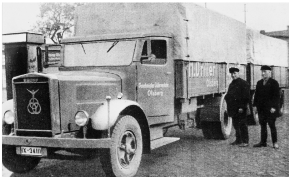
Krupp Junkers LD 5 N 132/142. Der hier abgebildete Krupp (5 Tonnen Nutzlast) wurde in verschiedenen Variationen von 1927 an gefertigt. Der Typ 5 N 132 besaß ab 1933 einen Dreizylinder Junkers Dieselmotor, der 5 N 142 einen Junkers Motor mit 4 Zylindern. Alle Krupp-Junkers Lastkraftwagen waren durch den Junkersengel auf dem Kühler über den drei Krupp-Ringen erkennbar. Die Typen LD 5 N 132 und 142 waren eigentlich nur durch einen Blick „unter die Haube“ zu identifizieren.
