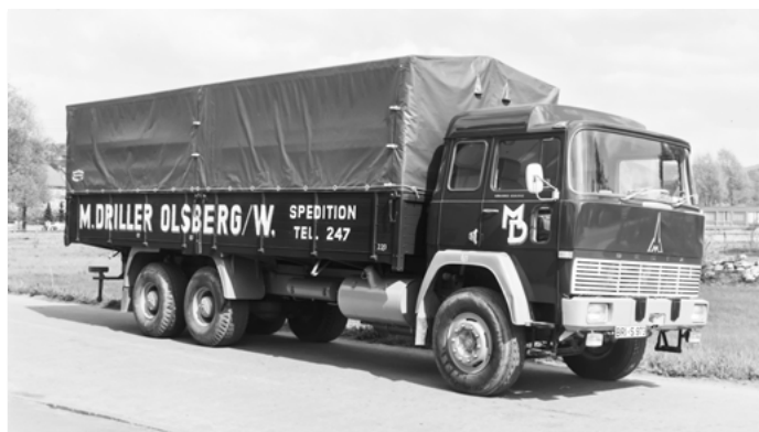
Magirus Deutz 250 D22, Bj. 1960er-Jahre, Schaltgetriebe. Motor 184 kW / 250 PS
