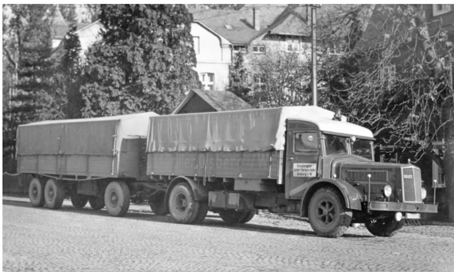
Krupp LD 6,5 N 242 Lkw 6,5t. Er wurde entweder von einem 110 PS Sechszylinder Vergasermotor oder einem 110 PS Vierzylinder Dieselmotor angetrieben.
