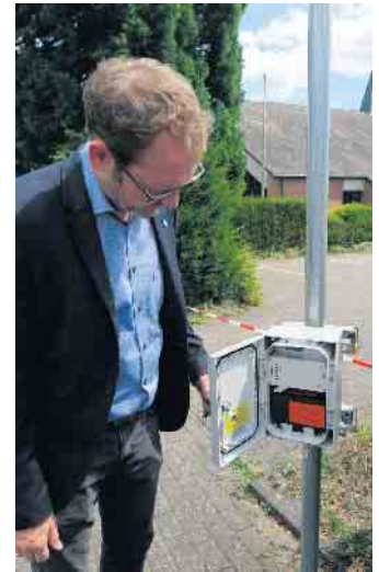
Mit dem Seitenradarmessgerät werden anonym Verkehrsdaten erhoben, auf deren Grundlage ggfls. Verbesserungen f. neuralgische Verkehrspunkte erstellt werden können. (Foto: Gemeinde Wachtberg/mm)
