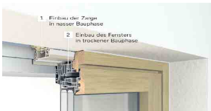
Ein zweistufiger Fenstereinbau mit Einbaurahmen bietet viele Vorteile.
