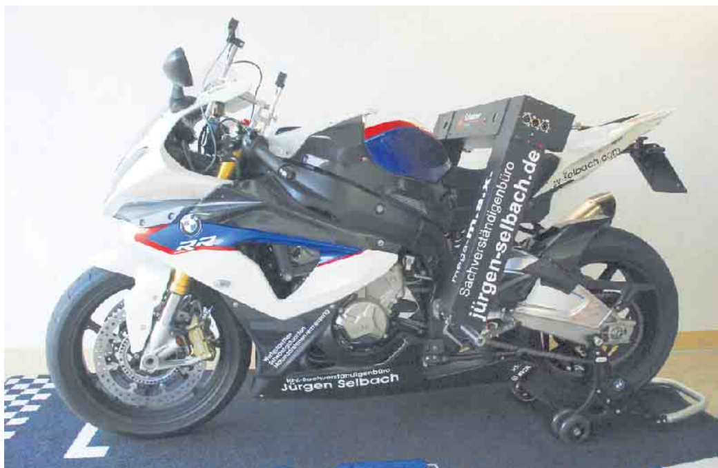
Spezialgebiet von Jürgen Selbach: Rahmenvermessung bei Motorrädern
