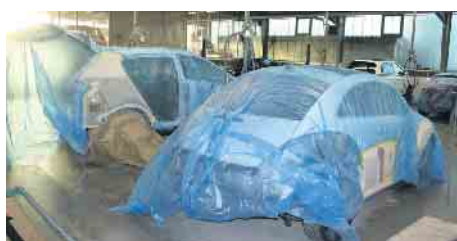
Schutz vor Farbnebel: Abdecken der nicht zu lackierenden Flächen
