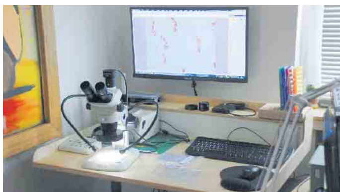
Die Lackteilchen werden dann unter einem Mikroskop untersucht.
