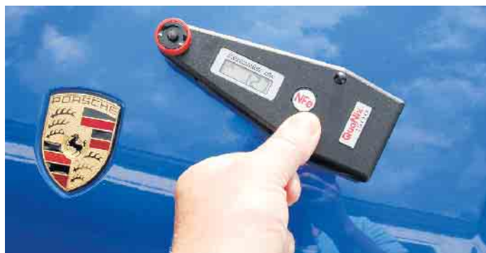
Unfallfrei oder nicht: Elektronische Messung der Lackdicke
