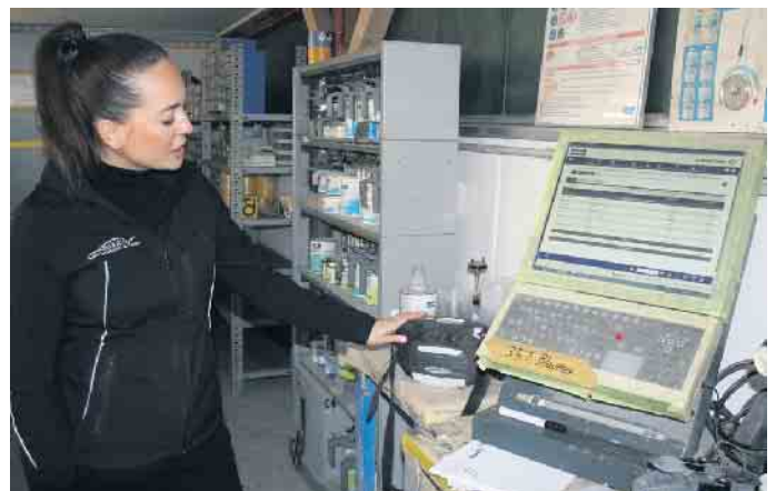
Die Chefin erklärt die elektronische Lacktonerfassung und Mischanlage.
