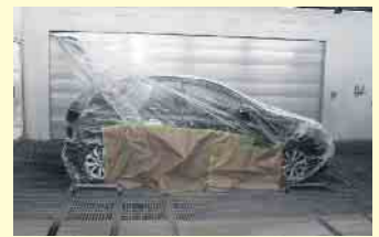
Auf Wagen montiert und seitwärts in die Lackierkabine geschoben
