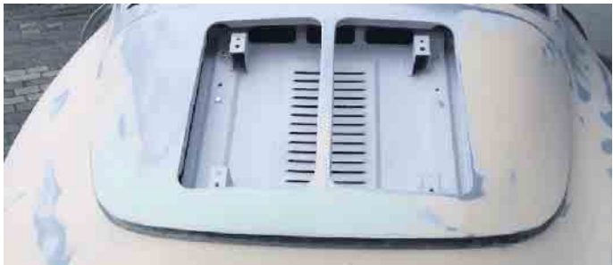
Die penible Vorarbeit mit Spachteln und Schleifen vor dem Lackieren ist sehr zeitaufwändig
