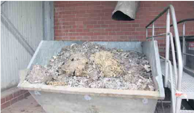
Die festen Abfälle aus dem Abwasser werden der Verbrennung zugeführt. (Foto: wed)
