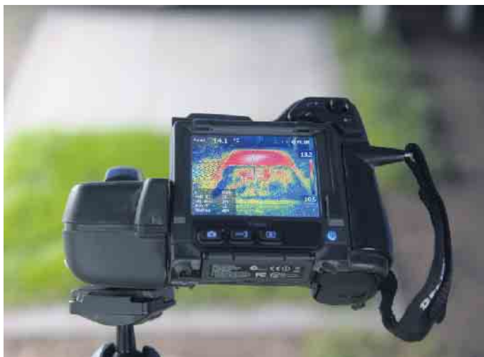
Der Abwasserbetrieb Troisdorf, AÖR (ABT) hat beim diesjährigen Energietag mithilfe einer Infrarotkamera eindrucksvoll vor Augen geführt, wie unterschiedlich die Wärmeabstrahlung von begrünten und versiegelten Flächen ist.
