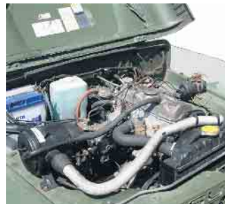
Unverwundlich: 0,8 Liter-Vierzylinder mit 40 PS und 60 Nm Drehmoment.
