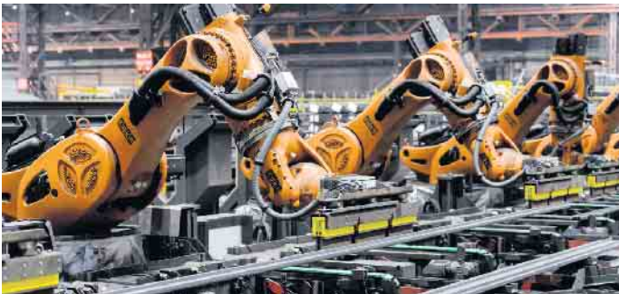
Roboter der Stapelanlage hinter der großen Walzstraße. Foto: Oliver Pracht
