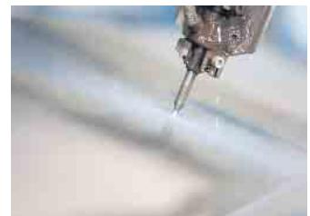
**So ein Wasserstrahl kann schon mal bis zu 0,7 Millimeter dünn sein!**
