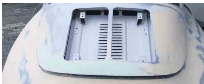
Die penible Vorarbeit mit Spachteln und Schleifen vor dem Lackieren ist sehr zeitaufwändig.
