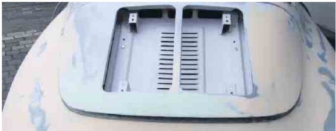
Die penible Vorarbeit mit Spachteln und Schleifen vor dem Lackieren ist sehr zeitaufwändig.
