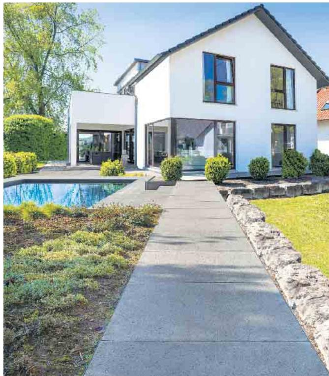
EXEO®-Platten im Megaformat können direkt im Splittbett verlegt werden. Die großzügigen Flächen punkten mit einem geringen Fugenanteil. (Foto: epr/KOLL Steine)
