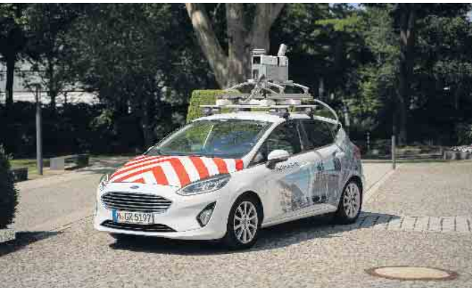
Im Auftrag der Stadtwerke Troisdorf und der Stadt Troisdorf wird ab dem 4. März das Troisdorfer Stadtgebiet mit einem auffälligen Aufnahme-fahrzeug befahren, das mit Kameras und Laserscannern ausgestattet ist und die Umgebung digital erfasst. Foto: Cyclomedia Deutschland GmbH
