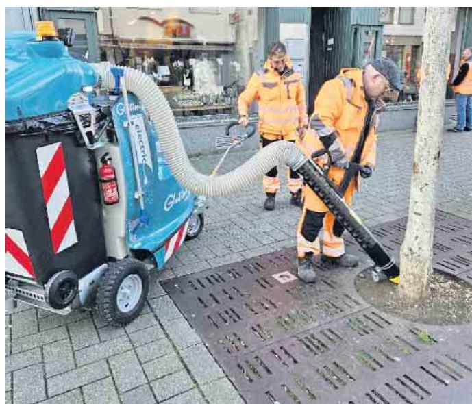
Neben der praktischen Abfallaufnahme ist der Glutton-Abfallsauger auch mit einem 60-Liter-Wassertank und einer Sprühlanze ausgestattet.
