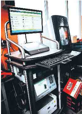
Motordiagnose von Bosch mit Fern-diagnose via Computer
