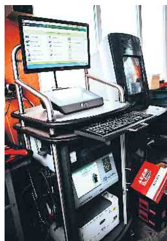
Motortester von Gutmann
