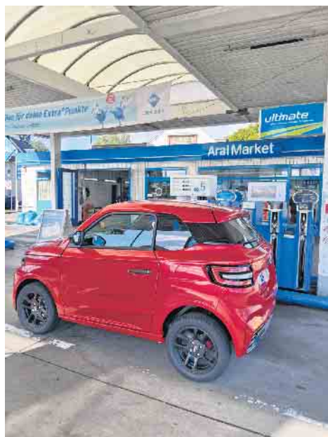
Der neue 0,5 Liter-Dieselmotor REVO D+ verbraucht zwischen 3,0 und 4,0 l/100 km.
