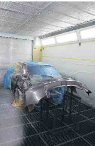
Staubfrei und perfekt ausgeleuchtet: Lackierkabine mit Abluftfilter
