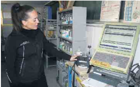
Computergestützt: Die elektronische Lacktonerfassung und Mischanlage
