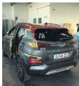
Bei Mattlack müssen angrenzende Flächen schon mal mit lackiert werden.
