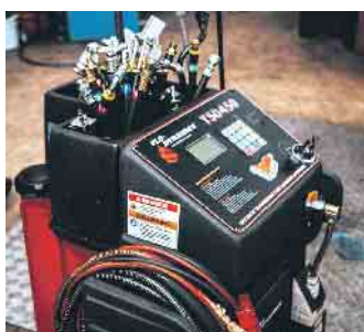
Automatikspülung mit Gerät von Flo-Dynamics
