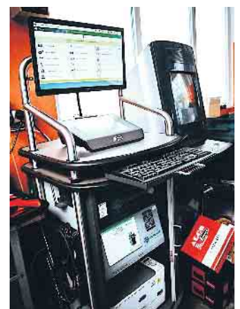
Motordiagnose von Bosch mit Ferndiagnose via Computer
