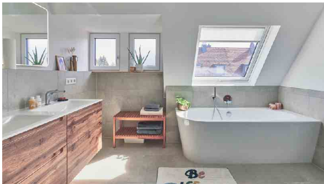
Dachfenster (rechts) und Gaube (links) in diesem Badezimmer zeigen den Unterschied: Während durch die Gaube mehr Wohnfläche mit voller Stehhöhe gewonnen wird, sorgt das Dachfenster für einen deutlich höheren Tageslichteinfall. Foto: Velux/Michael Christian Peters/akz-o
