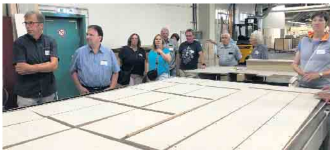
Das Zuschneiden der Platten wird computergesteuert um möglichst wenig Ausschuss zu produzieren. Lochbohrungen werden im gleichen Arbeitsgang durchgeführt.
