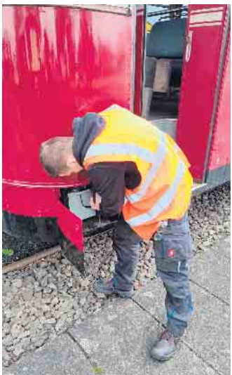
Die letzten Vorbereitungen für den Saisonstart laufen: Justus erneuert ein Scharnier im Batteriefach des VT98.
