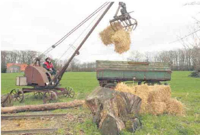
Carsten Stillig zeigte gern wie der historische Mistgreifer funktioniert. Aufwendig hatten die Altmaschinenfreunde das Gerät restauriert.
