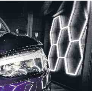
Wabenleuchten in der Annahme-Halle: So entdeckt man alle Schäden
