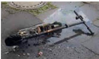
Schadensbild des abgebrannten E-Scooters
