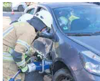
Mit einem Hydraulikspreizer wird die Tür aus den Scharnieren gerissen.
