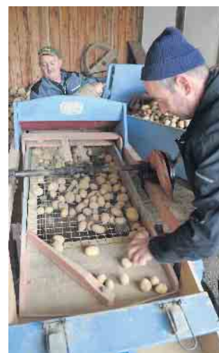
In der Sortiermaschine werden Kartoffeln nach Größe sortiert.
