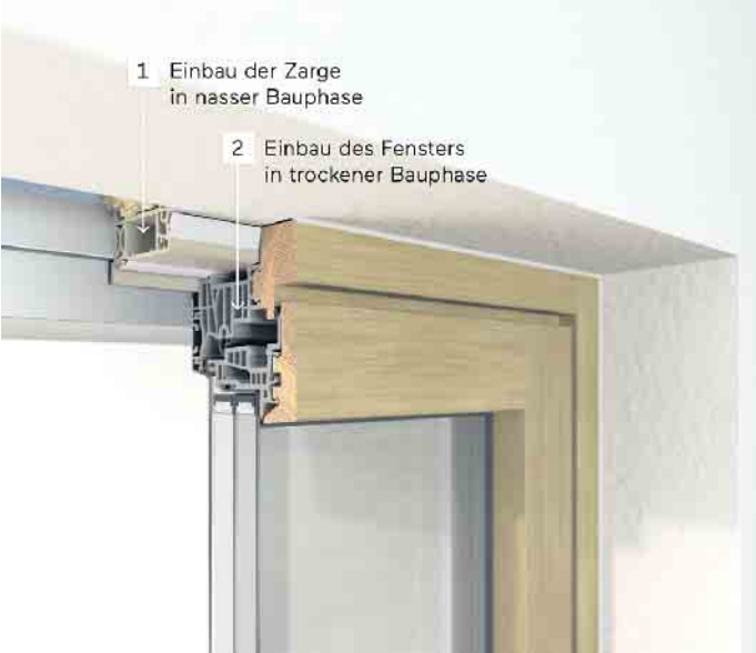
Ein zweistufiger Fenstereinbau mit Einbaurahmen bietet viele Vorteile. Foto: © Finstral
