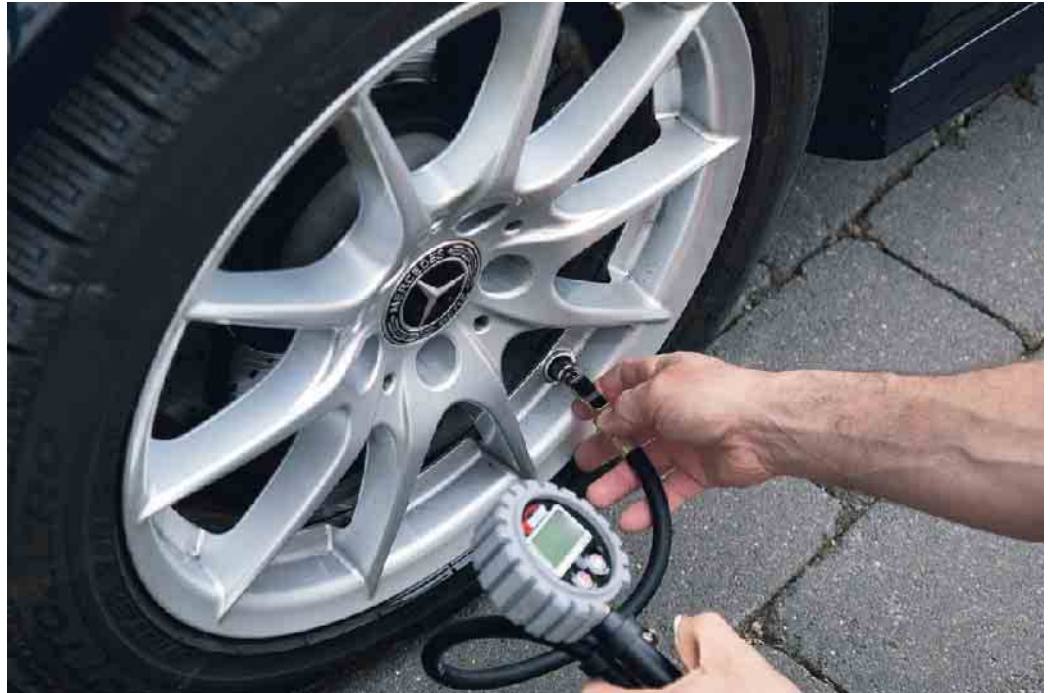
Autofahrer sollten den Reifendruck bei jedem Tankstellenbesuch überprüfen und gegebenenfalls anpassen. Foto: Dekra/mid/ak-o
