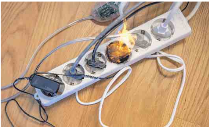
Brennende Steckerleiste durch Kurzschluss
