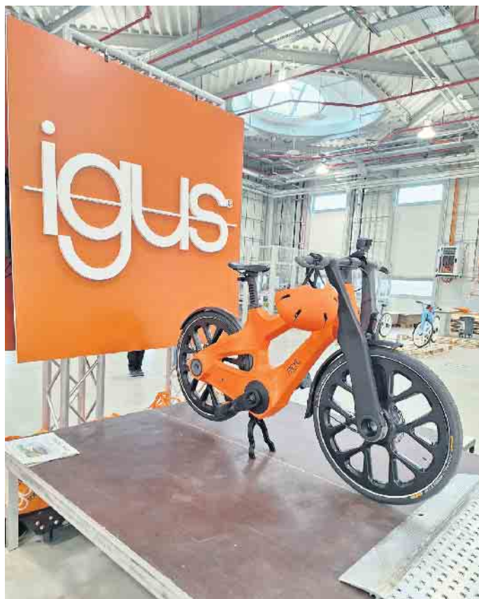
Das igus:bike - komplett aus Kunststoffen in Köln produziert
