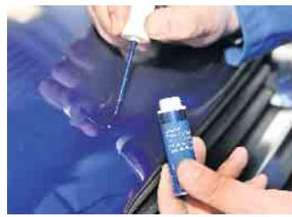
**Kleine Steinschläge im Lack lassen sich per Smart-Repair unsichtbar machen. Foto: djd/Kfzgewerbe**
