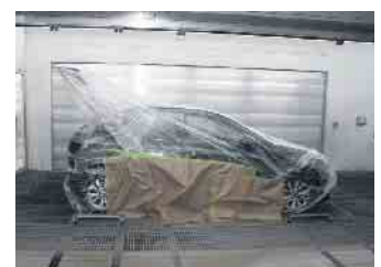
Auf Wagen montiert und seitwärts in die Lackierkabine geschoben
