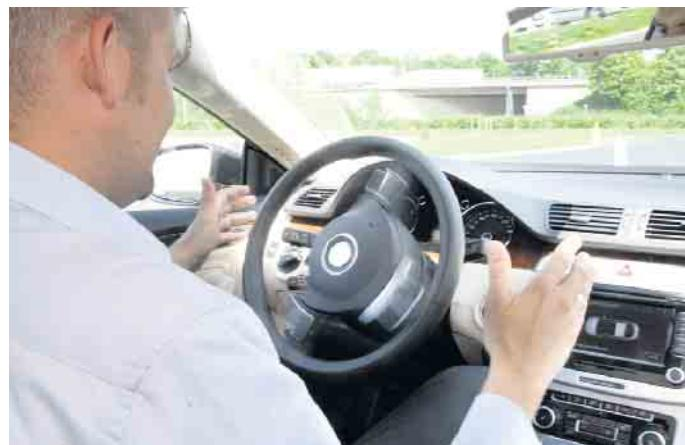
**Der Parkassistent ist das häufigste Fahrerassistenzsystem. Er schlägt, nachdem der Fahrer die vom Fahrzeug vorgeschlagene Lücke bestätigt hat, selbstständig im richtigen Moment das Lenkrad ein und übernimmt das Einparken nahezu vollständig. Foto: djd/Deutscher Verkehrssicherheitsrat**
