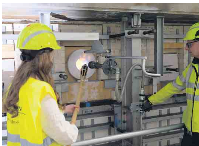
Das Entzünden der Schmelzwanne. Foto: Saint Gobain Glas
