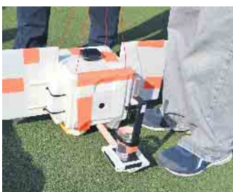
Am Ballon befestigt ist eine Sonde mit verschiedenen Messgeräten. Foto: Göllnitz
