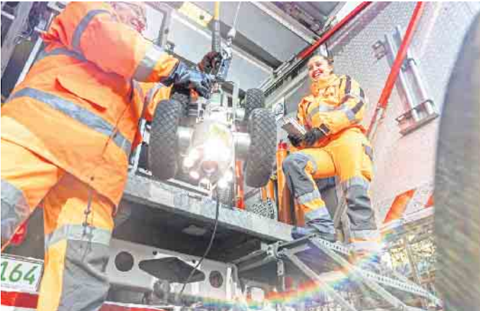
Hightech im Kanal: Ferngesteuerte Kameraroboter liefern scharfe Bilder, die anschließend mit KI-Unterstützung ausgewertet werden. Foto: DJD/VDRK/Sascha Krekla
