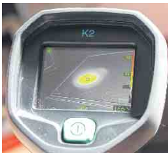
Wärmebildkamera im Einsatz (Herdplatte)
