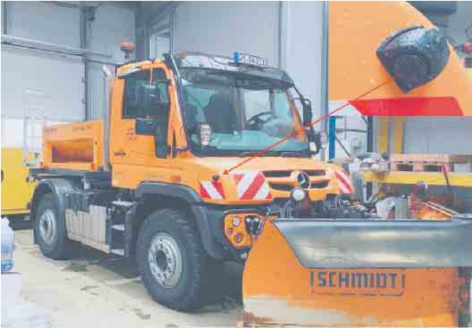
Unimog des Bauhofes mit montiertem Sensor des Abbiegeassistenten am rechten vorderen Kotflügel
