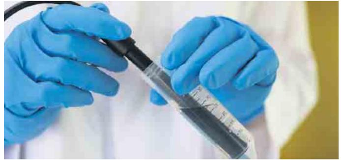
Spannender Einblick: bei der Probe wird die Leitfähigkeit des Wassers bestimmt
