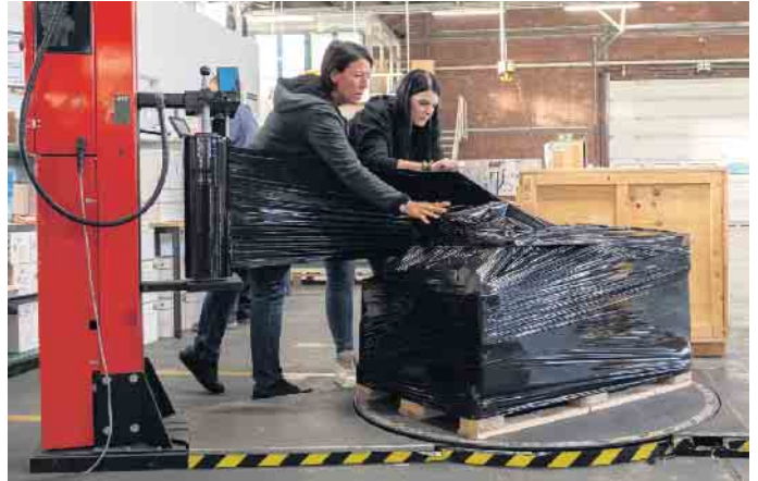
Erst werden die Pakete auf Paletten gestapelt, dann werden sie mit einer speziellen Folie umwickelt, damit sie beim Transport zu Land, zu Wasser und zu Luft gut geschützt sind.
