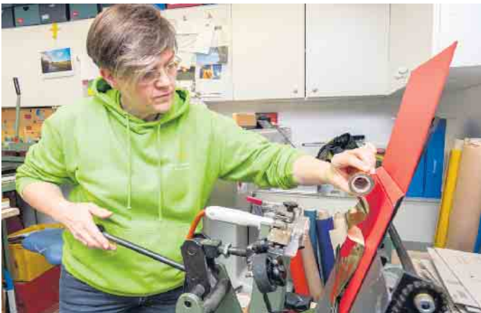
In der Prägemaschine ist das Klischee des Königs eingespannt, das die Gemünder Medienproduzentin Kathrin Wallraf entworfen hat. Gemeinsam mit der Goldfolie gibt das ein glänzendes Ergebnis. Foto: Ronald Larmann/pp/Agentur ProfiPress
