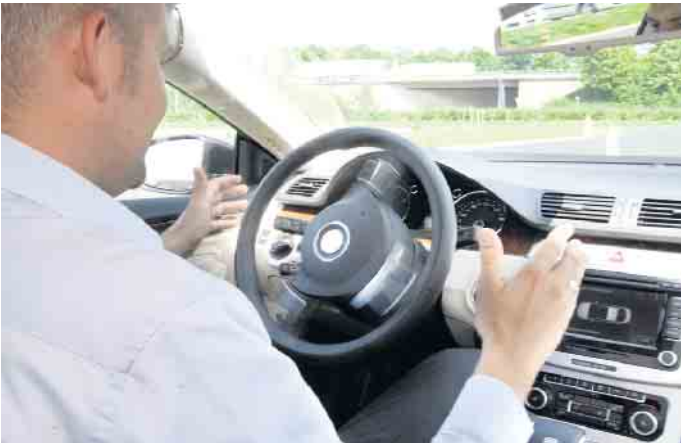
Der Parkassistent ist das häufigste Fahrerssistenzsystem. Er schlägt, nachdem der Fahrer die vom Fahrzeug vorgeschlagene Lücke bestätigt hat, selbstständig im richtigen Moment das Lenkrad ein und übernimmt das Einparken nahezu vollständig. Foto: djd/Deutscher Verkehrssicherheitsrat
