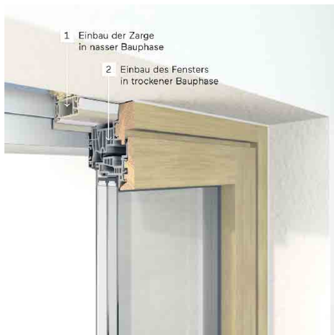
Ein zweistufiger Fenstereinbau mit Einbaurahmen bietet viele Vorteile.
