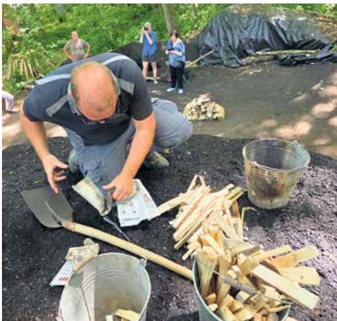
Konzentrierte Handarbeit auf dem Meiler: Markus Linden kontrolliert das Feuer im Inneren des Holzkohlenmeilers und sorgt mit Glut und „Anstochholz“ dafür, dass die Verkohlung kontrolliert in Gang kommt. Foto: Manfred Lang/pp/Agentur ProfiPress
